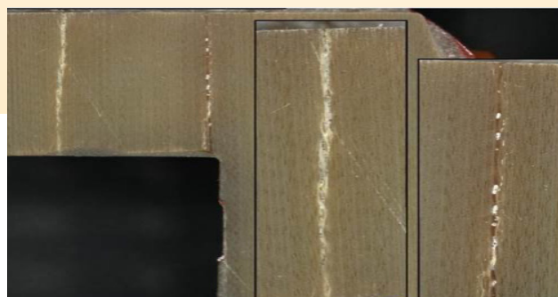
Figure 7 - Analyse de fissure sur une pièce de fibre de verre dans une composante électrique
